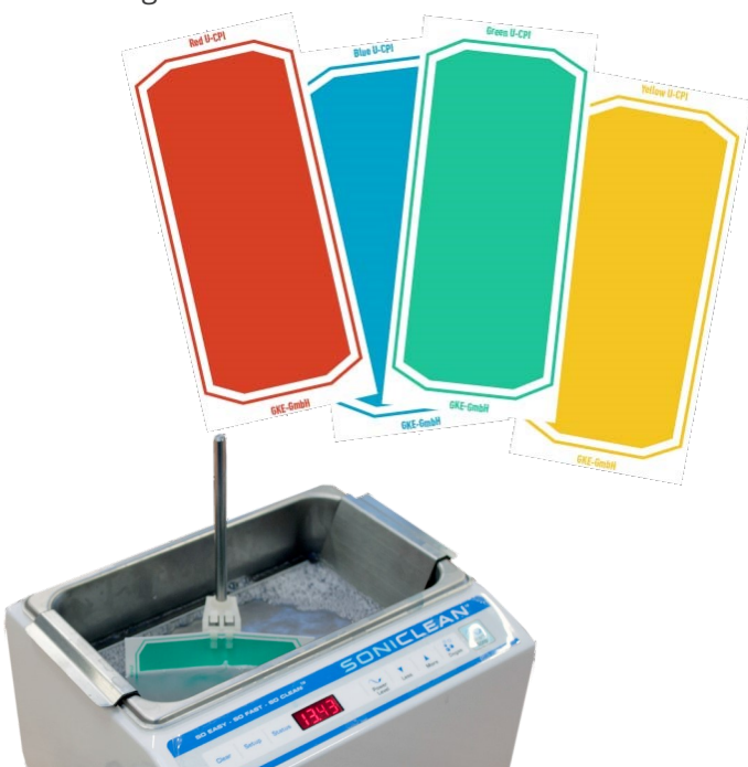
Anwendungsbeispiel: Stativ-Halter mit Testbogen im Ultraschallbad
