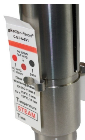
Anwendungsbeispiel eines Indikators im Kombinationsautoklav, z. B. Sirona DAC Universal
